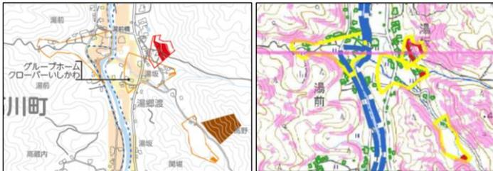
図4 ハザードマップ（左）と5mメッシュDEMを利用し、勾配30度以上の範囲を明示した図面（右）
