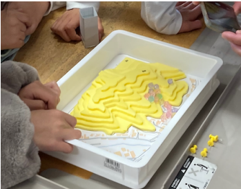
図 2 立体地形模型 (ビーズによる土石流実験)
