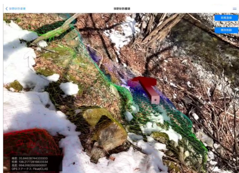
図-2 ナビ機能による点検ルート表示
