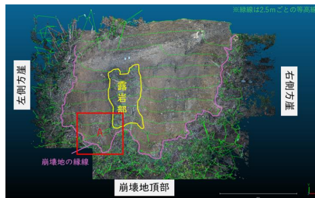
図4 崩壊地の3次元点群モデル
