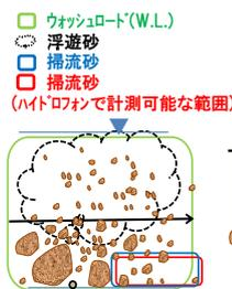
図-8 流砂の概念図 (左:小規模出水時 右:中～大規模出水時)
