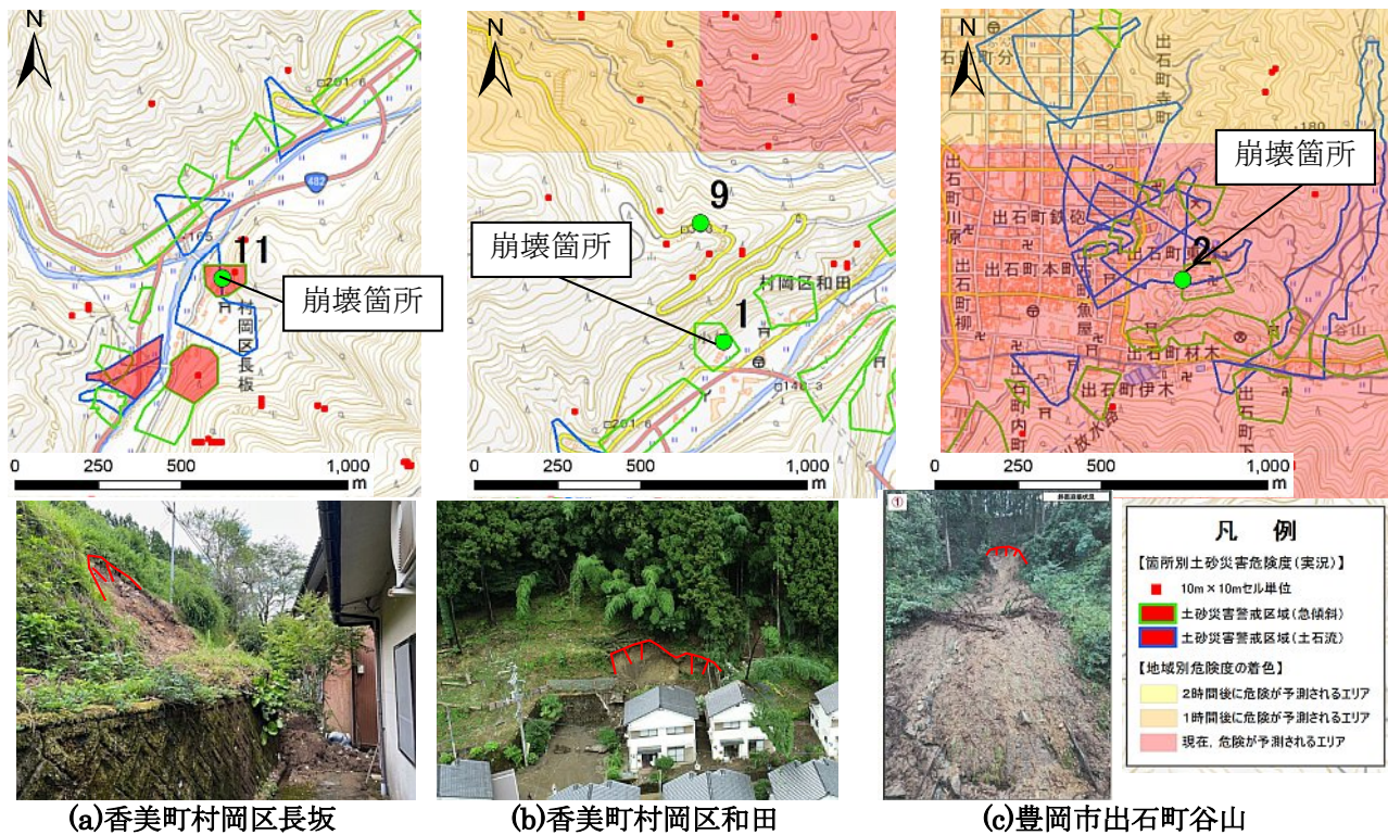
図 4 崩壊箇所とシステム判定結果および崩壊状況（写真は市町提供）
