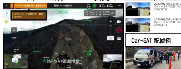
図-4 Car-SAT と Teams を組合わせた崩壊地の状況確認
