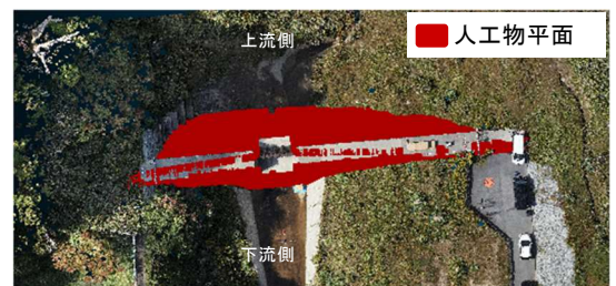
図7 RANSAC法による砂防設備の抽出結果
