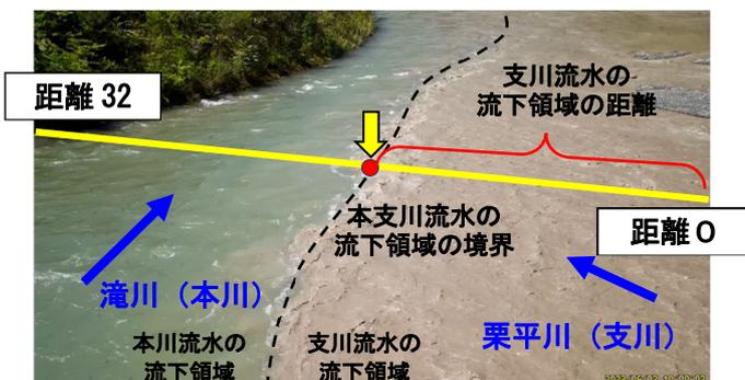
図 4 インターバルカメラでみた本支川流水の流下領域の境界
