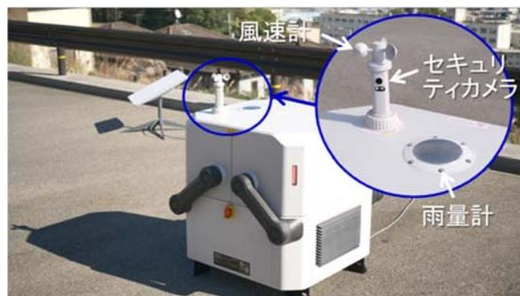
写真-1 ドローン格納庫「DJI DOCK」(外観)
