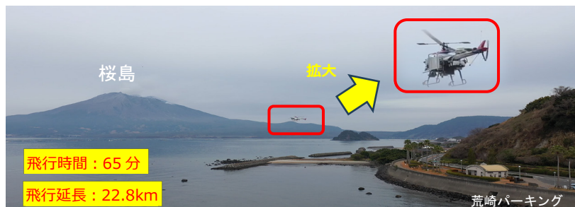
図-2 UAV を用いた砂防設備点検の様子
