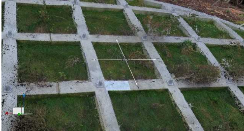
図－2 枠中心間隔の3次元計測状況(CASE1)
