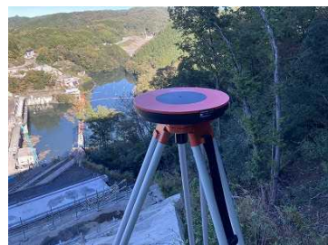
写真-3 GNSS ロガー内蔵対空標識
