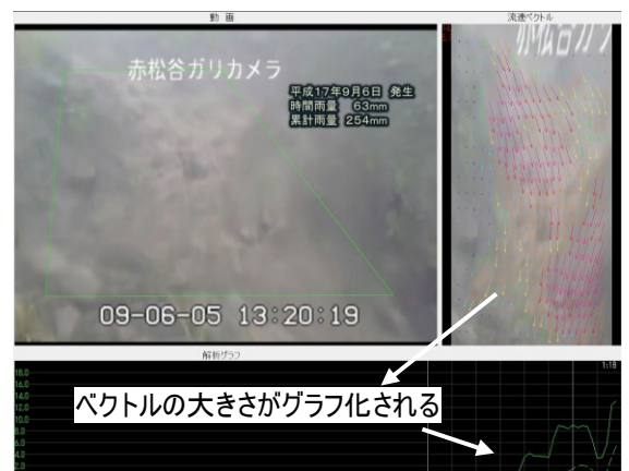
図5 OFを用いたCCTVカメラからの土石流検知見かけの流速計測とグラフ化例
