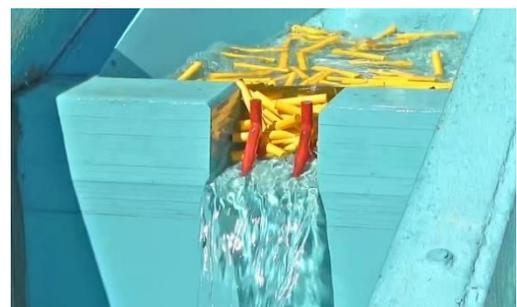
写真3 流木捕捉中の流況
