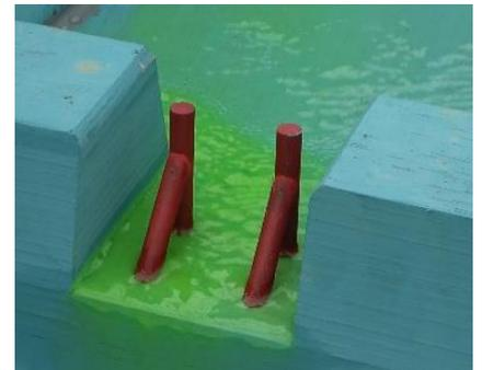
写真 1 流木捕捉工の模型モデル (第 1 案)
