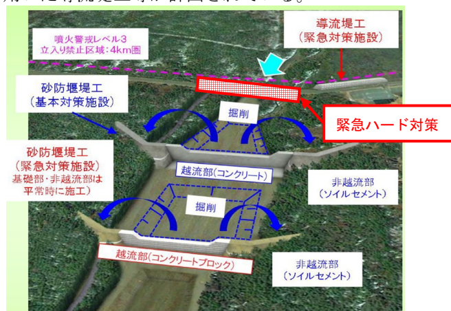
図 1 浅間山における砂防施設の名称とイメージ図 2)
