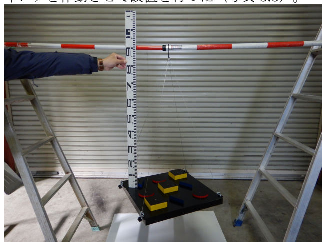
写真 3.2 降灰マーカーの吊り下げ状況
