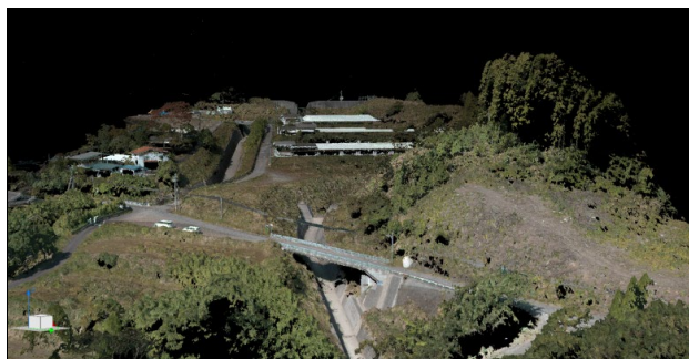
図 3 UAV 写真測量で作成した三次元データの例
