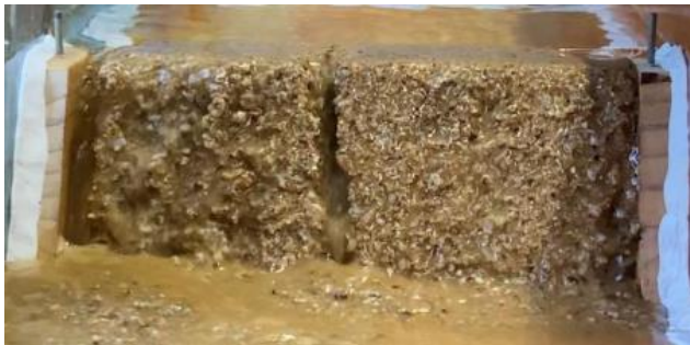
図4 ケース1の堤防模型の決壊時の様子
