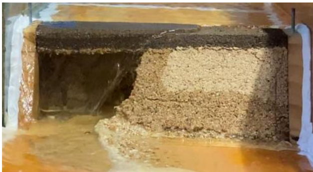
図5 ケース2の堤防模型の決壊時の様子
