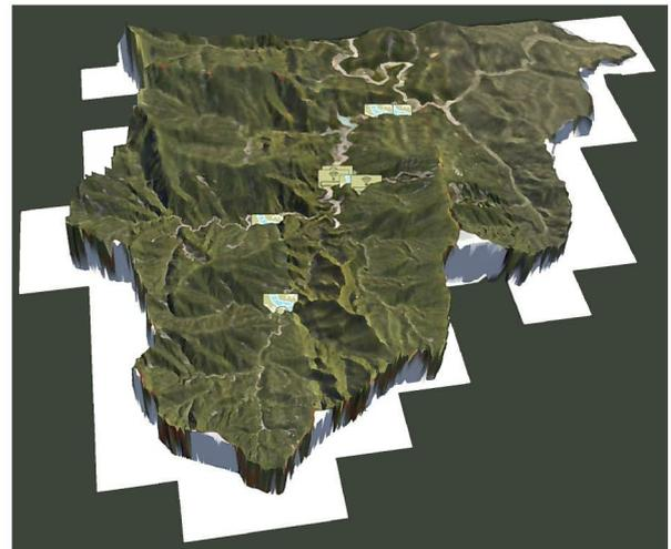
図1 航空レーザ計測データから作成した基盤図
