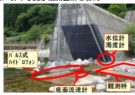
図-2 流砂観測設備の基本構成
