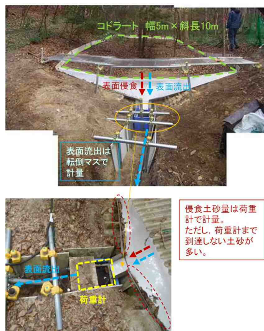
写真 1 表面流出・侵食土砂量の観測方法
