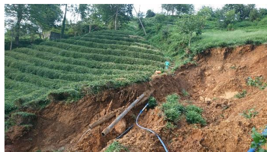
図 2 Rize 市の茶畑の地中に排水管が埋設されている様子（2019/9/9 撮影）
