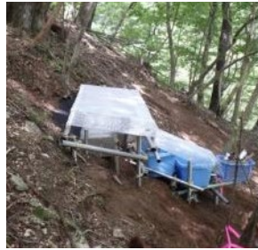
写真1 土砂捕捉装置
