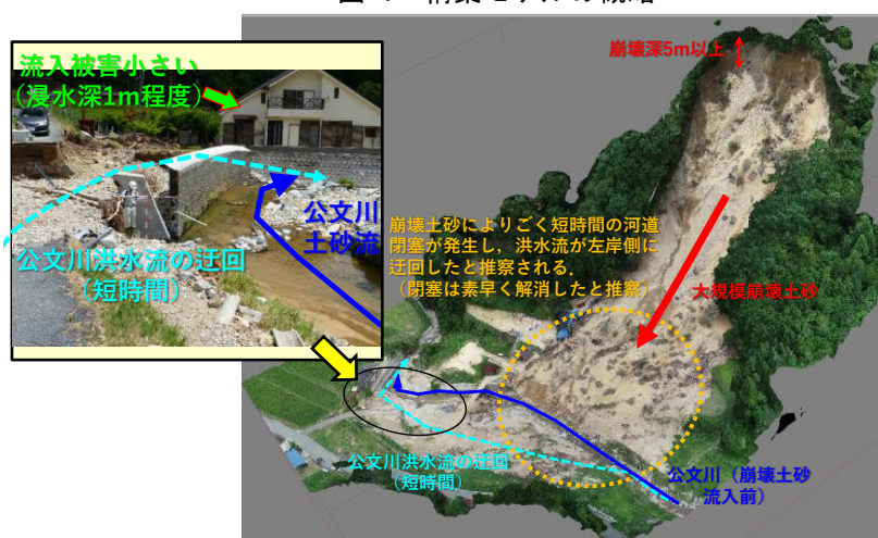
図-2 大規模崩壊土塊の流入による公文川短期閉塞と洪水流の迂回（背景図は2018年8月10日ドローン撮影画像の合成により作成）
