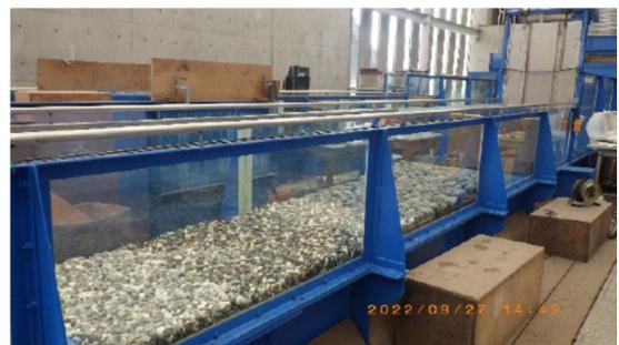
写真1 副堰堤下流の粗礫斜路の状態
