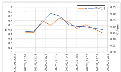
図2 洪水中の水深と $\alpha$ の時間変化 (上：①、下：②)
