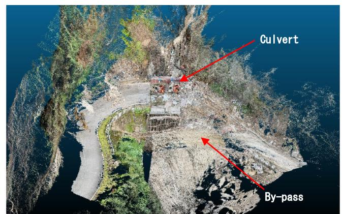
図2 施工前(左側)と施工中(右側)の重ね合わせー施工前後の盛土やカルバートの位置が対比可能ー
