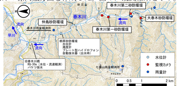
図1 早川支川春木川の位置図・計器類配置図
