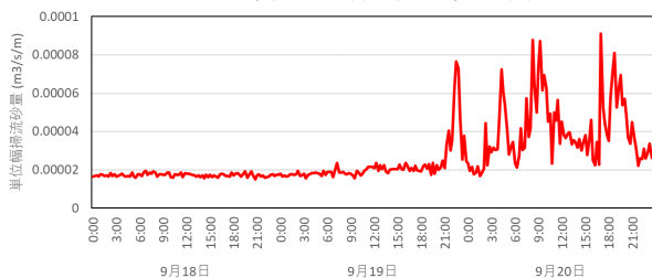
図6 ハイドロフォン観測結果(栃原砂防堰堤)
