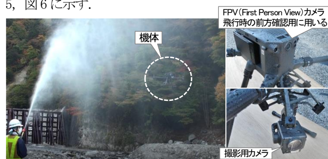
図5 高圧洗浄機を用いた人工降雨の実施状況
