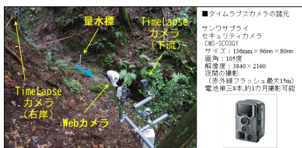
図-2 観測機器の設置状況
