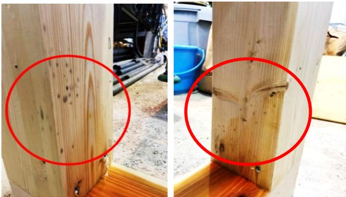
図3 ミニモデル6の木材の内側に発生したカビ
