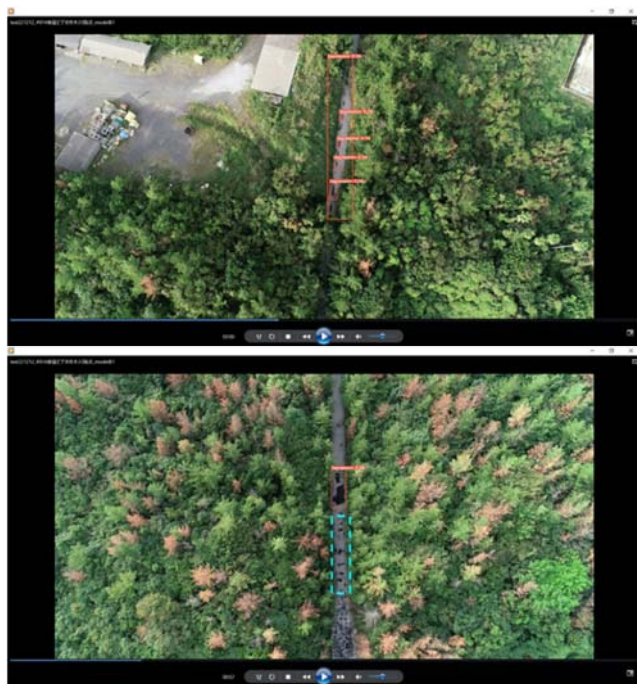
図 3 AI モデルによる陥没検出結果 (上：陥没を正しく検出、 下：小さな陥没（水色枠内）を見逃し)
