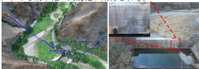
図.3 自律飛行軌跡(左図), UAV 撮影写真(右図)
