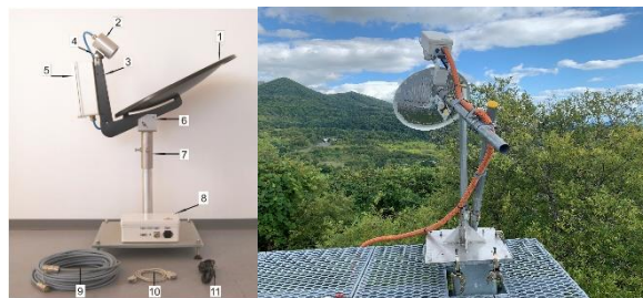
図 2. 左図は MRR のシステム構成要素。右図は三豊中継局にて, アンテナを有珠山頂に向けて観測しているときの様子。
