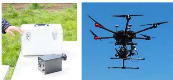
図1 マルチスペクトルカメラと搭載した状態の UAV
