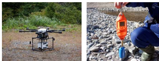
図5 計測機器(左: UAV-ALB、右: 水中音速度計(CastAway-CTD))
