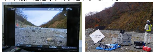
図-4 衛星通信による映像伝送試験
