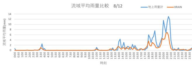
図-3 地上雨量計と XRAIN の流域平均雨量比較 (8/12)
