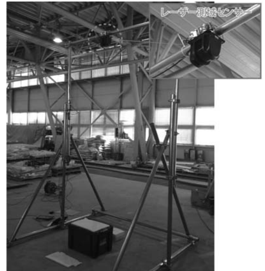
図-3 レーザー測域センサー試験風景
