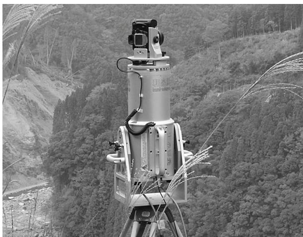
図-2 長距離型レーザスキャナ Riegl LMS-Z420
