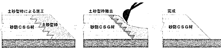
図-2 土砂型枠による地表部構造物の施工
