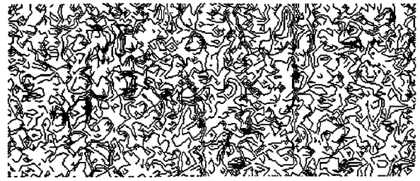
図-3 ずれた2組のデータを重ねた等高線図 図-2のずれた点群を合わせ、1cm等高線を作成すると、ずれた分だけの等高線が見える。ここでは平均して約4cm(等高線4本分)の凹凸がある。砂質の川原なので大きな凹凸はない。
