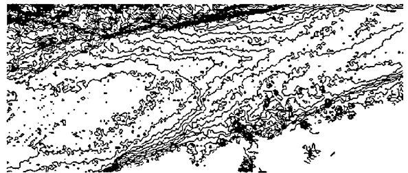
図-5 差分を修正、合成後作成した5cm等高線図 砂州の形状が正確に表現された。
