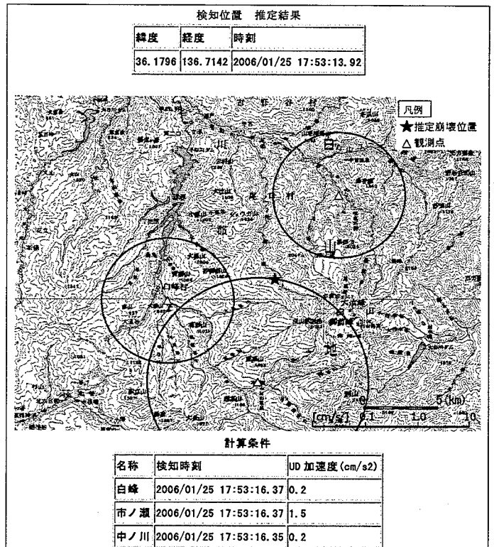
図1 手取川上流直轄砂防事業区域内振動センサー観測データに基づく土砂崩壊位置推定システムイメージ図
