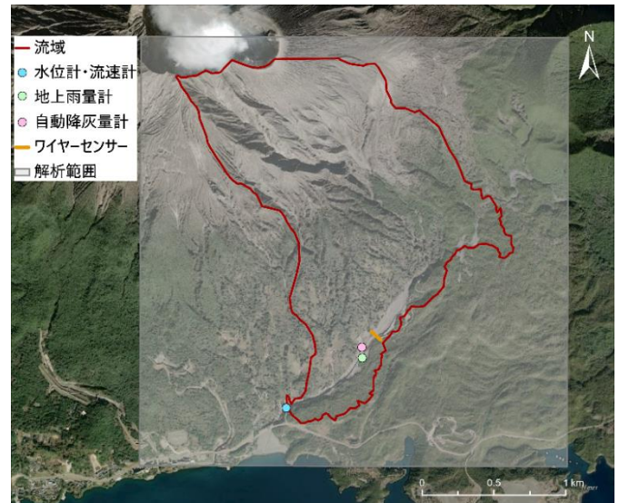
図1 対象地図および土石流観測機器の位置関係
