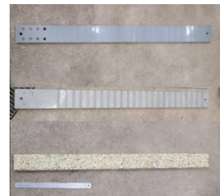
図 2 用いた粗度板(上から順に B0、B1、B2)
