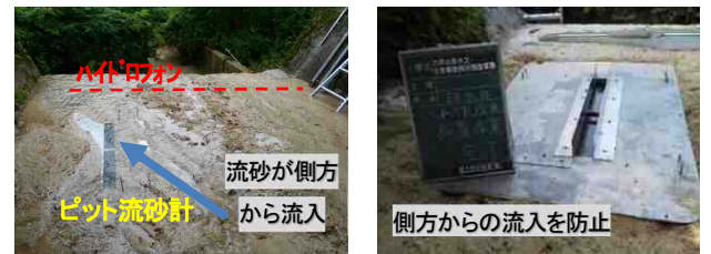
写真 2 ピット流砂計の蓋の改良
