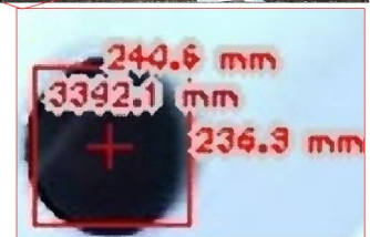
図3 把持装置に装着したステレオカメラ画像と A I画像解析によるセンターホールの認識結果の例
