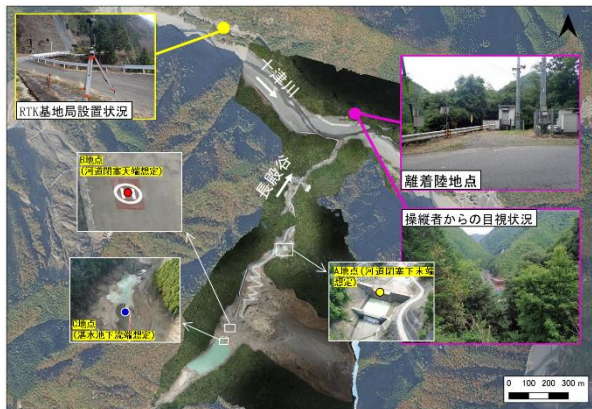
図. 4 UAV 離発着地点とレーザ計測箇所
