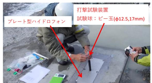
図-4 簡易打撃試験の実施
