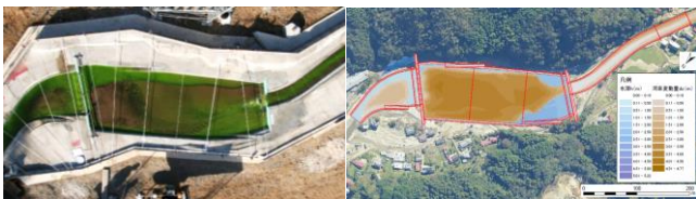
図-2 五福谷川遊砂土工の実験・二次元計算結果の例
